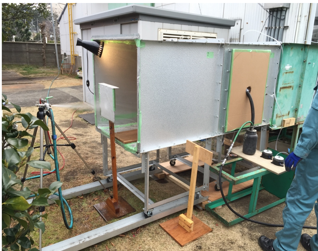
図 35 耐圧試験ダクトの外観
