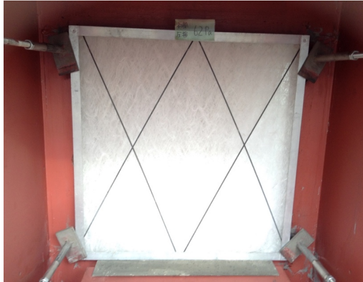
図 37 耐圧試験時のプレフィルタ状態写真(圧力損失 62Pa)
