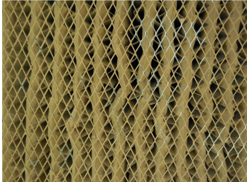
図 44 ろ材亀裂部分の拡大写真(圧力損失 2700Pa)
