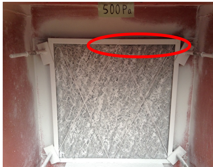
図 38 耐圧試験時のプレフィルタ状態写真(圧力損失 500Pa). 赤円で示した部分に隙間が発生.
